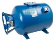
100 literes membrános hidrofor tartály. Membrán EPDM. Előzetesen 1,8 barig levegővel megtölthető. Tartály a hajzi vászonzártály berendezésével alkalmazható. 1" csatlakozás. Max. általános nyomás 4 bar. Általában minden helyzetben használható.
