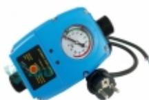
Víz-zsap nyitására inél automatikusan bekapcsol, lezárására inél kikapcsol. Szűrőszabályozó elleni védelemmel ellátott. Abban a pillanatában, ha a rendszerben elfogy a víz automatikusan kikapcsol, megakadályozva a berendezés károsodását. Csatlakozás 1col x 1col. Max 10 bar nyomásig alkalmazható. Indítási áramerősség 10A, ¼zemi 6A. A be-és kikapcsolási nyomás szabályozható, ezáltal nyomáskapcsolóként is használható. A készülék mágneses védett tartállyal és anélkül is
